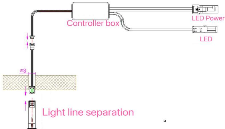
2. Insérez l'interrupteur de contact de porte connecté dans le stratifié perforé (comme indiqué dans la figure ci-dessous).
